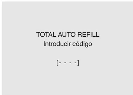
Introduciendo el "código de carga" (por defecto 1234) los contadores se ponen a cero y el aparato empieza a funcionar normalmente.
