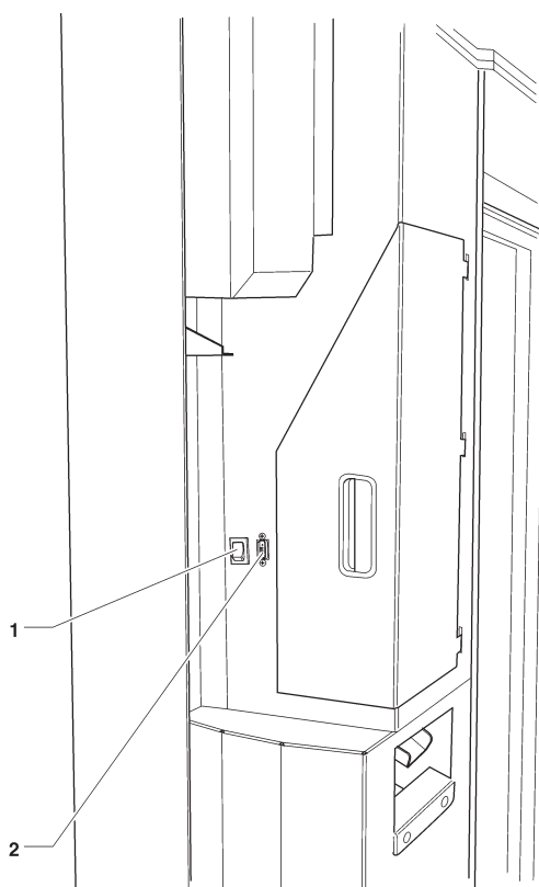
Fig. 51 1- Pulsante ingresso programmazione 2- Connettore seriale RS232
