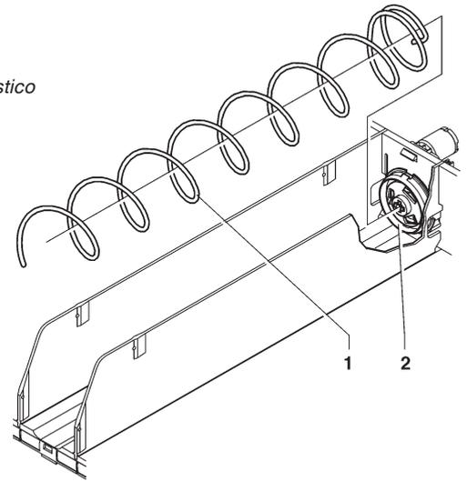
Las espirales se pueden colocar con variaciones de 22,5 grados tirándolas hacia adelante y girándolas en sentido de la expulsión. Los productos se distribuyen sin problemas cuando el extremo de la espiral está colocado hacia abajo y en el centro. Con la ayuda de la tabla siguiente y de la fig. 23, conociendo el paso y el sentido de las espirales, se pueden obtener las dimensiones generales y el número de productos que se pueden distribuir.
