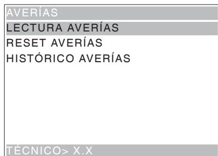
El aparato está dotado de diversos sensores para tener bajo control los diferentes grupos funcionales. Cuando se detecta una anomalía, el display de la máquina visualiza el tipo de avería y el aparato (o parte del mismo) se coloca fuera de servicio. Las averías detectadas se memorizan en contadores especiales, las averías gestionadas por el software pueden ser relativas a grupos funcionales no presentes en el modelo específico; que de cualquier modo se elencan cuando se recorre el menú.
